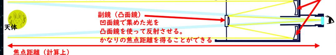
(焦点距離：凹面鏡に当たった光が集まるまでの位置を焦点距離といい、望遠鏡の倍率に関係する。)
